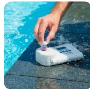
Figure 4: Testeur Spectrophotomètre pour piscines publiques
